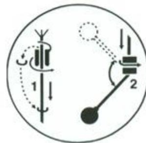
2、轻轻地推动重锤拉出电缆，直到重锤中心扣住塑胶环。重锤只要轻扣在塑胶环中即不会滑落，此塑胶环如有损坏或遗失，可用同轻裸铜线扣入电缆代替。
