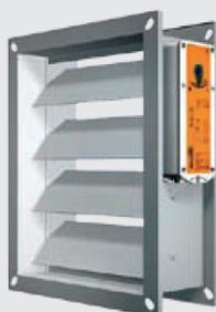
栅栏式密封防烟阀由自复位执行器驱动，防止烟尘在通风系统内蔓延。防烟阀由烟尘探测器触发。
