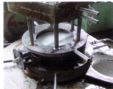
每台阀门都要通过 1.1 倍的公称压力 17.6bar 的气泡级密封性能检测
