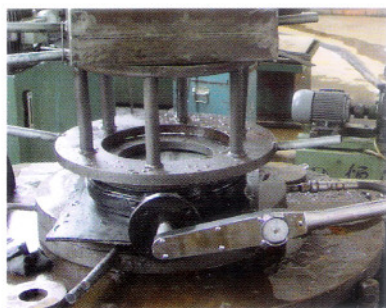
每批阀门都要通过在公称压力下进行的模拟极度工况开启力矩检测
